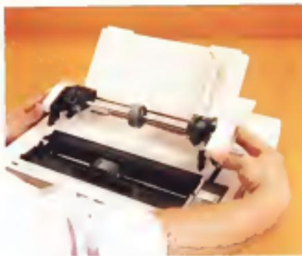
ne sono alloggiati sul pannello posteriore, in proposito per evitare che utilizzando il modulo continuo esso si strappi o si spieghi a contatto con i cavi, è fornita una plicchieria plastica ad incastro che prolunga il piano superiore di inserimento della carta quel tanto che basta per evitare i possibili inconvenienti descritti.
